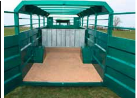
Höhe des Dachs bei 2,10 Meter
