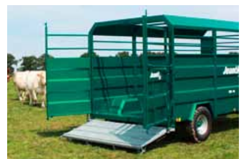
In Verladeposition absenkbare Brücke
