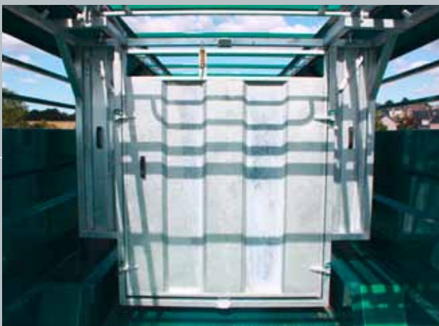
Einteilig verschiebbare Trennwand auf Schiene
